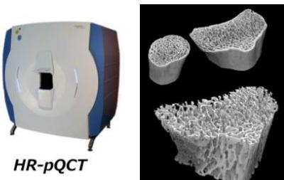
特に骨微細構造解析グループでは、2015年8月にHR-pQCT (High Resolution peripheral Quantitative CT)と呼ばれる高解像度CTを日本で初めて導入し、骨粗鬆症の画像解析など、世界最先端の研究を行っています。
